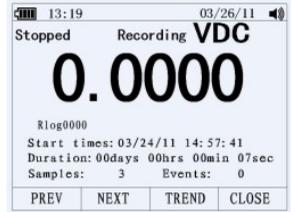
Si hay registros previamente guardados, presione la tecla F1 (PREV) para cambiar las páginas o presione la tecla F2 SIGUIENTE (NEXT) para desplazarse en la dirección opuesta. Presione F4 CERRAR (CLOSE) para regresar al modo de funcionamiento normal.
