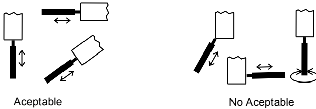
Figura 1 – Ángulos correcto e incorrecto para medición
