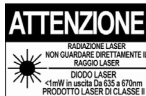
**Attenzione:** Non fissare direttamente il raggio laser usando sistemi ottici come binocoli o telescopi. Questo può creare un pericolo.
