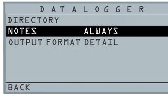
2. Se l'opzione **Notes** è impostata su Sempre (**Always**), la lettura di spessore viene memorizzata nella posizione ID [lineare], [riga], [colonna] con le note. Per modificare le impostazioni delle note, selezionare l'opzione Note dalla schermata *Datalogger* nel menu principale.
