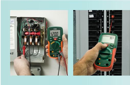
两个型号都是自变换量程真有效值仪表，在测量失真波形时，可提供更准确的读数。EX210T 带有内置式红外测温计，可快速进行非接触式温度测量。
