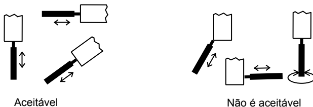
Figura 1 – Ângulos de Medição Corretos e Incorretos
