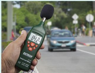
このデュアルレンジ・サウンドレベルメーターは、ANSIとIEC 651 Type 2スタンダードに適合しています。職場の騒音調査、火災報知器やスピーカーシステムの設置、そして騒音に関する条例強化に最適です。測定範囲は35~130dBの2レンジで、精度は±1.5dBです。データホールドと最大ホールド機能も搭載。バックライトディスプレイにより、暗い場所での使用も可能です。
