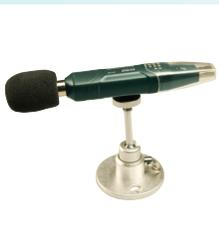
最大129,920までの測定値を記録し、USBインターフェースを使用してPCのセットアップとデータダウンロードが簡単に行なえます。データロガーはANSIとIEC 61672 Class 2スタンダードに適合し、精度は1.4dBです。その他の機能として、AとCの重み付け、速い/遅い反応時間、2つの開始方法（PCからプログラムまたは手動）などが挙げられます。メーターの位置決めと連続したデータ記録に便利な三脚台を付属しています。
