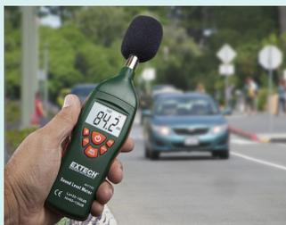
このタイプ2サウンドレベルメーターキットは、ANSIとIEC 651 Type 2スタンダードに適合しています。職場の騒音調査、火災報知器やスピーカーシステムの設置、そして騒音に関する条例強化に最適です。測定範囲は35~130dBの2レンジで、精度は±1.5dBです。データホールドと最大ホールド機能を搭載。バックライトディスプレイにより、暗い場所での使用も可能です。メーターとキャリブレーション用のプラスチック製キャリングケースを付属しています。
