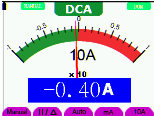
Figura 9: Medición de corriente CD 10A
