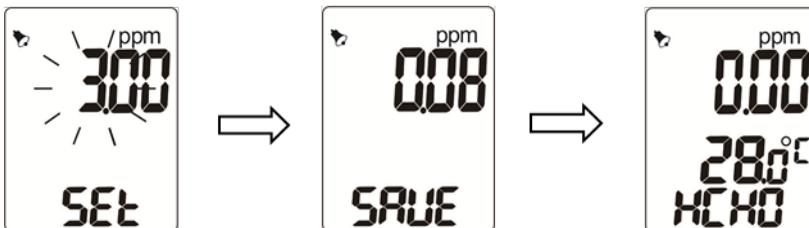
**Nota:** El icono de la campana se muestra en la esquina superior izquierda de la pantalla LCD cuando la alarma está activada. Presione momentáneamente el botón **POWER** para armar o desarmar la alarma.
