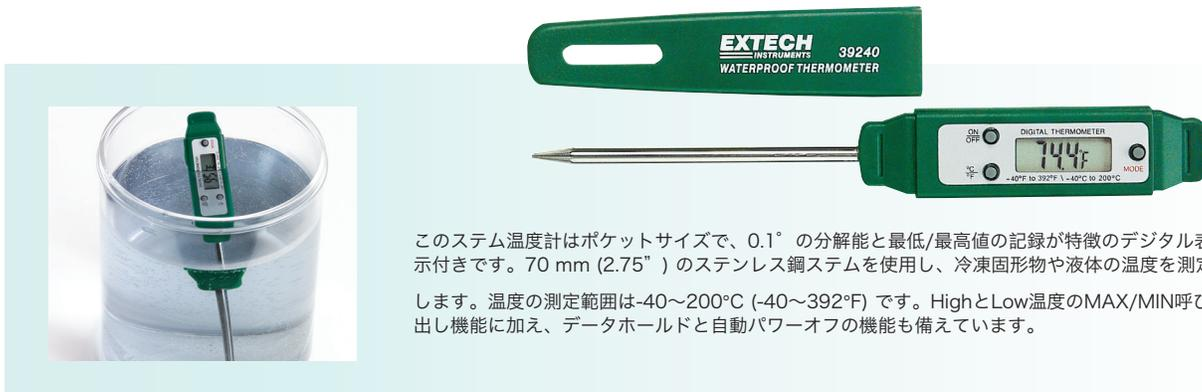
このステム温度計はポケットサイズで、0.1° の分解能と最低/最高値の記録が特徴のデジタル表示付きです。70 mm (2.75" ) のステンレス鋼ステムを使用し、冷凍固形物や液体の温度を測定します。温度の測定範囲は-40~200°C (-40~392°F) です。HighとLow温度のMAX/MIN呼び出し機能に加え、データホールドと自動パワーオフの機能も備えています。
