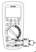
**Nota:** La sonda para temperatura está equipada con un mini conector tipo K. Se suministra un adaptador de mini conector a conector banana para conectar a los enchufes de entrada.
