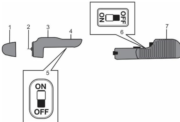
**OBSERV. IMPORTANTE:** O MO270 é enviado com os dois interruptores LIGA/DESLIGA ajustados em DESLIGA. Por favor, consulte o diagrama acima para localizar estes interruptores. Por favor, LIGUE esses interruptores a fim de permitir a operação de medição adequada.
