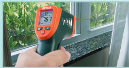
检查窗和门周围有无热损失
