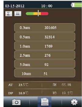
Starten Sie mit der Taste BETRIEB/STOPP die Luftpumpe und den Partikelanzahl-Messvorgang. Wenn die programmierte Abtastdauer abgelaufen ist, wird der Partikelmesszyklus automatisch beendet und die Messdaten werden automatisch gespeichert. Zum Einstellen der Abtastdauer schlagen Sie im Abschnitt Partikelanzahl SETUPMODUS nach. Wenn gewünscht, beenden Sie mit der Taste BETRIEB/STOPP die Sitzung manuell.
