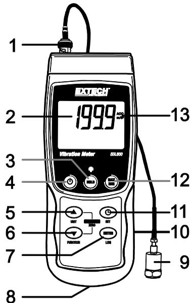
**Hinweise:** Der Punkt "10" befindet sich hinter der aufklappbaren Abdeckung auf der rechten Seite des Messgeräts.
