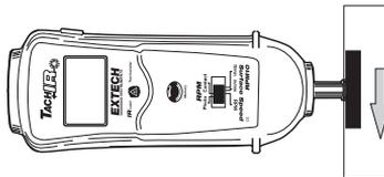
1. Installer la roue de vitesse linéaire sur l'arbre de contact.
