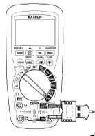
**Nota:** A sonda de temperatura é equipada com um conector do tipo mini K. É fornecido um mini conector para o adaptador para plugue banana para a conexão às tomadas banana de entrada.
