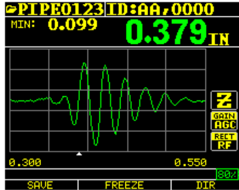
Ein HF-Signal mit auf dem Kopf stehenden Cursor „V“ zeigt an, wo die Messung gerade durchgeführt wird
