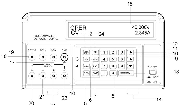
1. OPER/STBY: Botón de operación / espera. Presione para activar / desactivar la salida. Cuando la fuente está en modo de espera (STANDBY) la salida es de 0 voltios.
