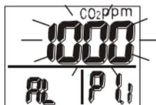
Usare i tasti freccia ▲ ▼ per regolare il valore. Ogni pressione del pulsante regola di 100 ppm (100 ~ 9900 ppm). Quando il valore desiderato è impostato, premere **SET** per accedere a P1.2 per impostare il limite inferiore (usando lo stesso metodo del limite superiore). Al termine, premere **SET** per salvare o **CAL/ESC** per uscire senza salvare e tornare a P1.0.
