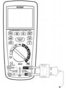
**Remarque :** La sonde de température est équipée d'un mini-connecteur de type K. Un adaptateur mini-connecteur-fiche banane est fourni avec l'appareil pour permettre le branchement aux prises banane.
