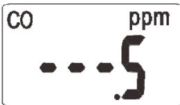
Nota: Si el medidor indica '----5', presione el botón de control para pasar al siguiente ajuste.
