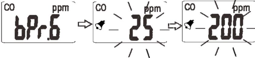
El zumbador de alarma advierte al personal para evacuar un área debido a la detección de concentraciones peligrosas de CO. El medidor suena la alarma cuando la concentración de CO supera el valor predeterminado o umbral programado por el usuario.
