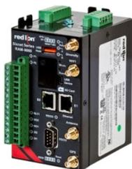
4. Antennen mit SMA-M-Stecker können direkt oder über ein Koaxialkabel an der RTU angeschlossen werden. Die Antenne(n) sollten die nachfolgend aufgeführten Spezifikationen erfüllen. Weitere Informationen über Antennen finden Sie im Hardware-Handbuch .
