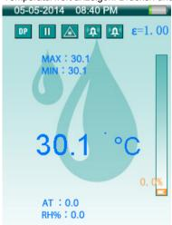
Im Dew Point Modus zeigt die Prozentsatzanzeige die Nähe zwischen IR-Temperatur und Taupunkttemperatur. Bei 100 % sind beide Werte identisch.
