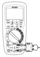
**Remarque :** La sonde de température est équipée d'un mini connecteur de type K. Un mini connecteur relié à l'adaptateur de connecteur banane est livré avec l'appareil pour tout branchement aux prises d'entrée banane.
