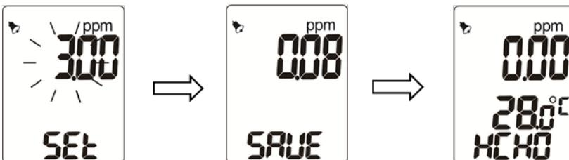
**Hinweis:** Wenn der Alarm scharf geschaltet ist, wird oben links auf der LCD-Anzeige ein Glockensymbol angezeigt. Drücken Sie kurz die Taste **POWER** um den Alarm unscharf oder scharf zu schalten.
