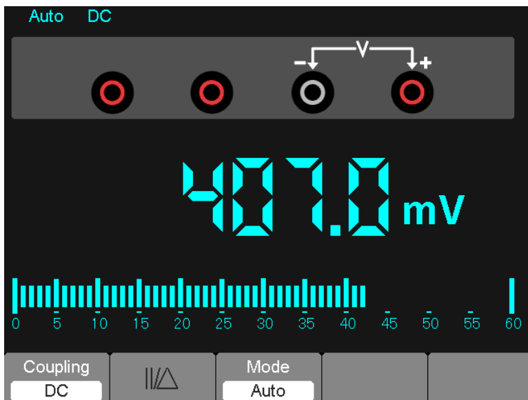
Figura 7-6 Medición de voltaje CD
