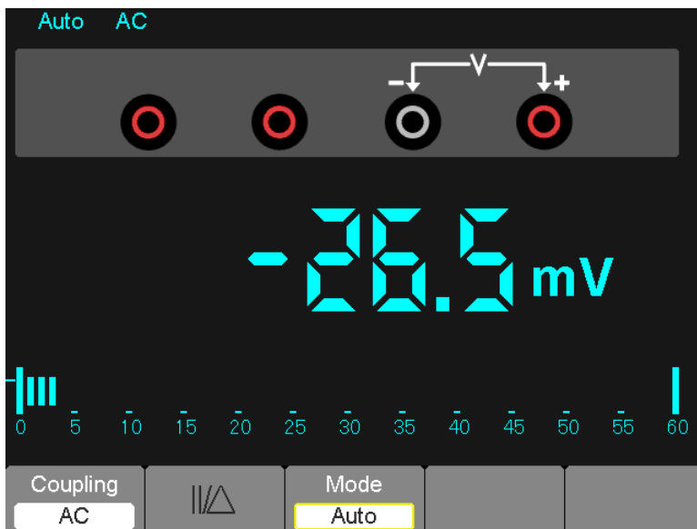
Figura 7-7 Medición de voltaje CA
