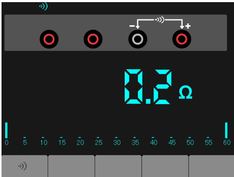
Figura 7-4 Medición de continuidad
