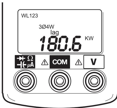
5. 要读出单个数据记录, 应按下保持按键, 选择WL1, WL2, WL3或WL123显示内容, 按下量程按键, 选择KW+HP(马力), KW+PF(功率系数), KW+KVAR, KVA+0(相角)或A+V显示内容。
