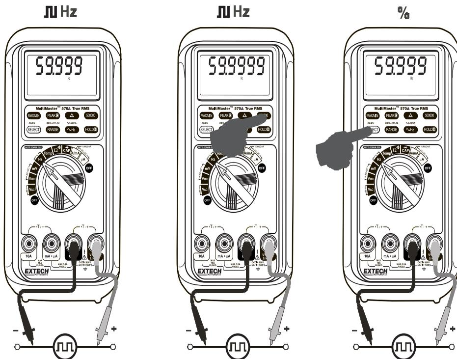
Remarque : À la différence de la fonction de mesure Fréquence de niveau de ligne précédemment décrite, cette fonction Fréquence de niveau logique est définie uniquement à la sensibilité d'entrée la plus élevée pour la mesure des signaux électroniques de type numérique.
