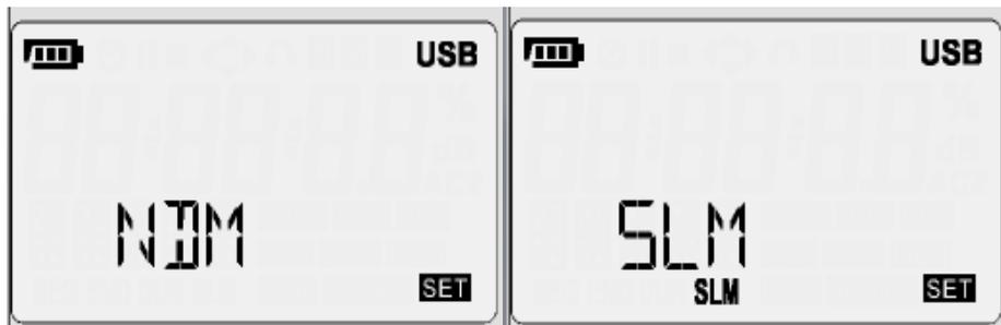
Pressione o botão ▲ ou ▼ para alternar o modo de teste entre NDM (Dosímetro de Ruído) e SLM (Medidor de Nível Sonoro).
