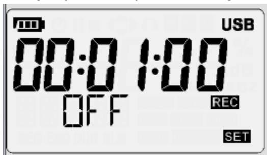
Use o botão ◀ ou ▶ para selecionar a Gravação Automática ou o Tempo de Amostragem. Use o botão ▲ ou ▼ para ativar ou desativar a Gravação automática (On ou Off) ou para ajustar o tempo de amostragem. O tempo de amostragem mínimo (taxa de intervalo) é de 1 leitura por segundo. O tempo de amostragem máximo é de 23 horas, 59 minutos e 59 segundos. Pressione o botão SET para avançar para o próximo parâmetro ou pressione Enter ↵ para sair do modo de configuração.
