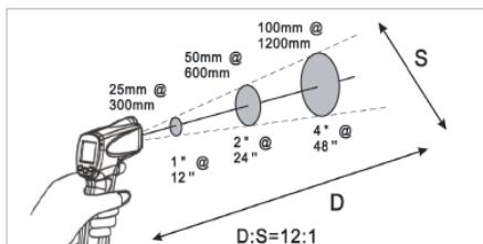
Es ist notwendig sicherzustellen, dass das Messobjekt größer als der Messfleck des Thermometers ist. Je kleiner das Messobjekt ist, desto größer sollte der Abstand betragen. Sehen Sie sich das beigegebene Diagramm an.
