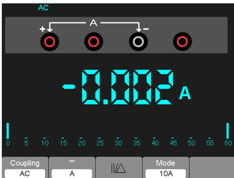
Figura 7-11 Medição de Corrente AC para 10 A
