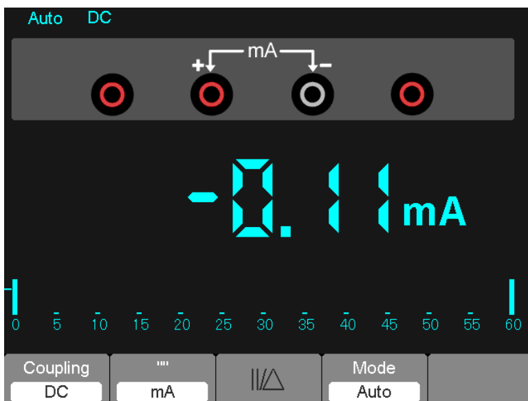
Figura 7-8 Medição de corrente DC para 600 mA
