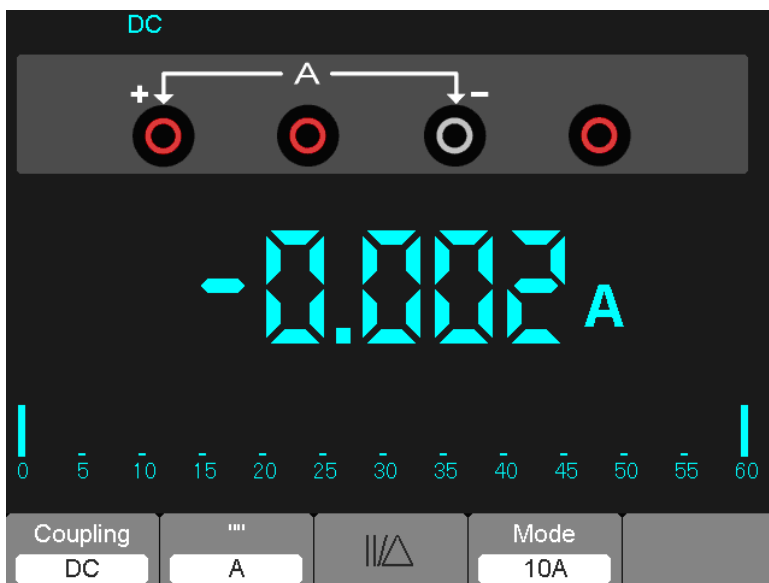
Figura 7-9 Medição de Corrente DC para 10 A
