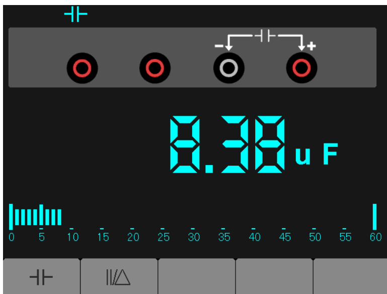
Figura 7-5 Medição de Capacitância
