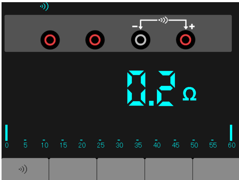
Figura 7-4 Medição de Continuidade
