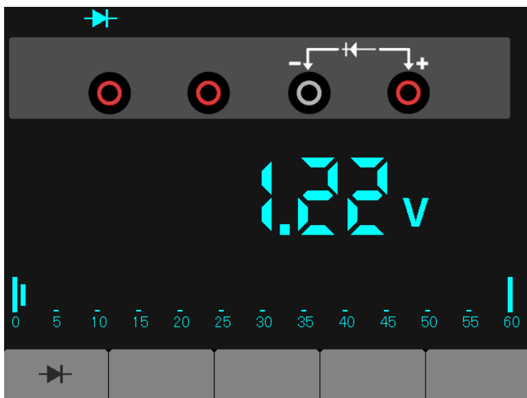
Figura 7-3 Medição de Diodo
