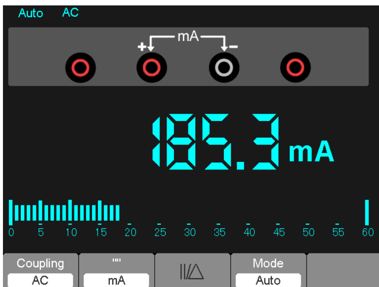
Figura 7-10 Medição de Corrente AC para 600 mA
