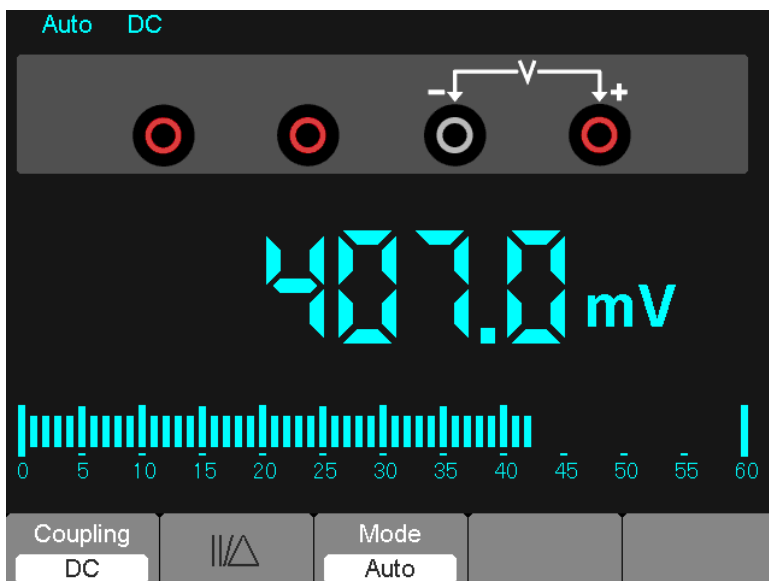
Figura 7-6 Medição de Tensão DC
