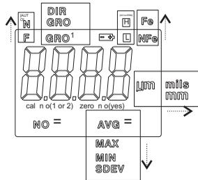
Hinweis: Das Maßeinheit-Icon blinkt im CONTINUOUS Betriebsmodus. Im SINGLE Betriebsmodus wird das Maßeinheit-Icon dauerhaft angezeigt.
