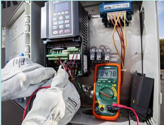
这些专业的 DMM 载有先进的特性和功能。低阻抗 (LoZ) 模式避免了因虚电压而导致的错误读数。低通滤波器 (LPF) 会减弱高频率, 以减轻频率噪声、获得精准读数。真正的 RMS 在测量失真或嘈杂波形时会提供精准的读数。内置的非接触式交流电压检测器在测试之前快速检查是否存在交流电压。
