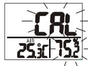
**OBS.:** As calibrações de ponto simples são permitidas. Para calibrar apenas a 33%, pressione **CAL/Esc** e saia quando a calibragem a 33% é completada. Para calibrar apenas a 75%, pressione **MODE/▲** em 5 minutos durante a inicialização de calibragem a 33%.
