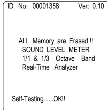
2. Apague el medidor y enseguida presione juntos los botones **STORE** y **RECALL**. Encienda el medidor (ON) y suelte las teclas cuando la pantalla indique “toda la memoria borrada” (*ALL Memory Erased*)”
