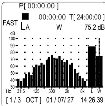
3. Use el botón **FREQ WGHT** para seleccionar el ajuste de ponderación de frecuencia  $L_A$ ,  $L_C$  ó  $L_P$ .
