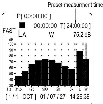
3. Use el botón **LM/ 1/1/ 1/3** para seleccionar la pantalla de medición de la banda de nivel de presión de sonido MNS de 1/1 ó 1/3 octava.
